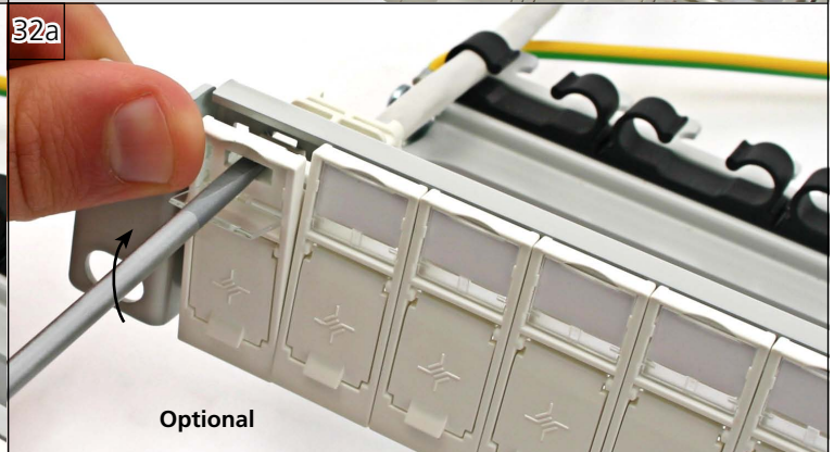
Demontage des Moduls / Demounting of module
